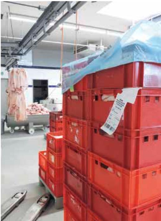
Für jede Wiegeeinheit – hier Speckseiten am Haken – wird am Wareneingang ein Schlaufenetikett ausgedruckt, angehängt und als Wareneingangscharge geführt. / A loop label is printed out at goods receipt for each weighing unit - in this case, bacon pages on the hook -, attached and managed as a goods receipt batch.
